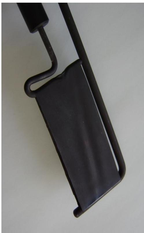
La membrane est l'organe de détection du capteur **OILSPY**.
