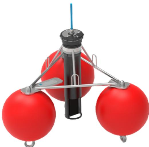
La membrane du détecteur est constamment en contact avec la surface de l'eau, permettant une détection efficace des hydrocarbures flottants. De par son architecture, cette bouée est parfaitement adaptée aux courants modérés, avec variations de niveau d'eau.
